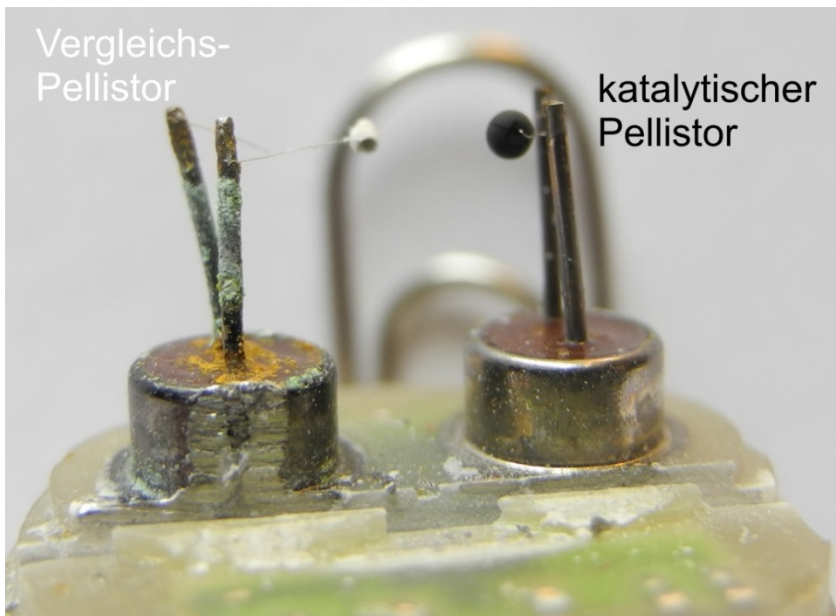
Abbildung 5 Größenvergleich eines Pellistors mit einer Büroklammer
